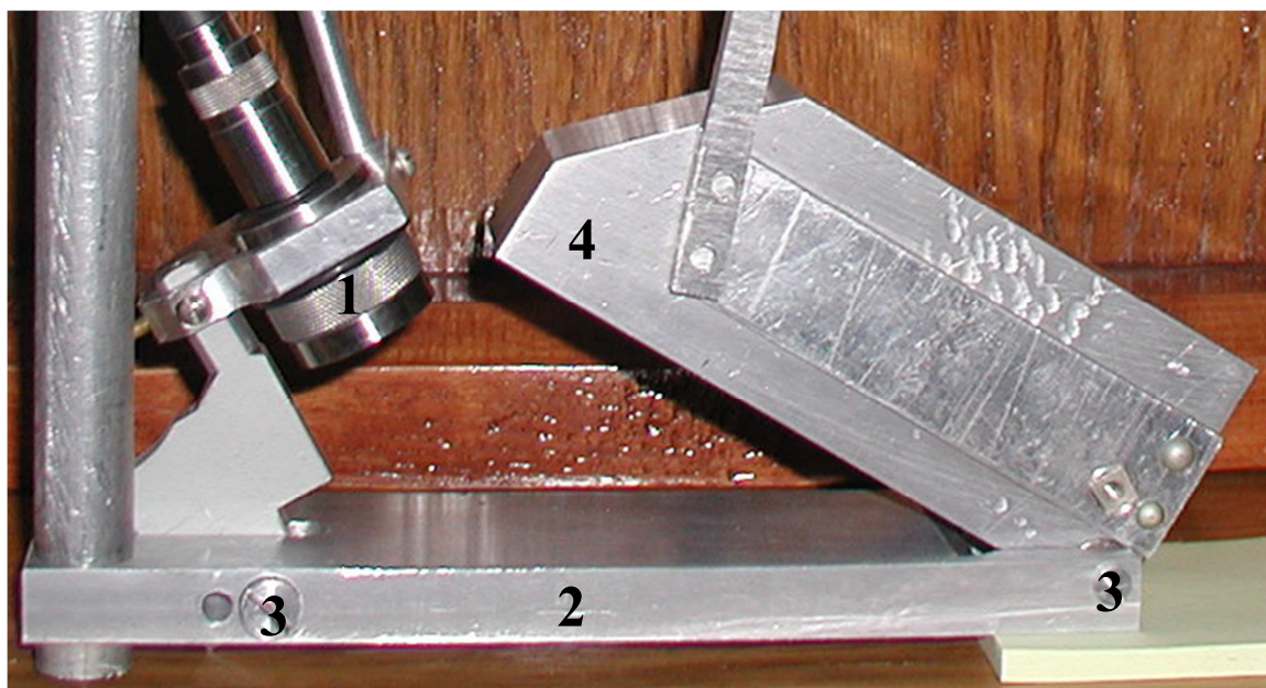
Рис. 10. Экспериментальная установка по наблюдению тонкой структуры волны утечки. 1 – преобразователь, 2,4 – алюминиевые пластины, 3 – крепёжные винты для регулировки наклона пластин
